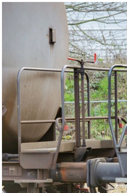
Abbildung 39: Feststellbremseinrichtungen auf der Pufferbrücke
