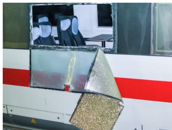
Abbildung 46: Notausstiegswindeln lassen sich nach außen wegdrücken
