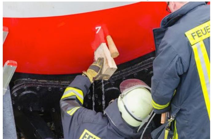
Abbildung 19: Abdichten eines Risses im Kessel
