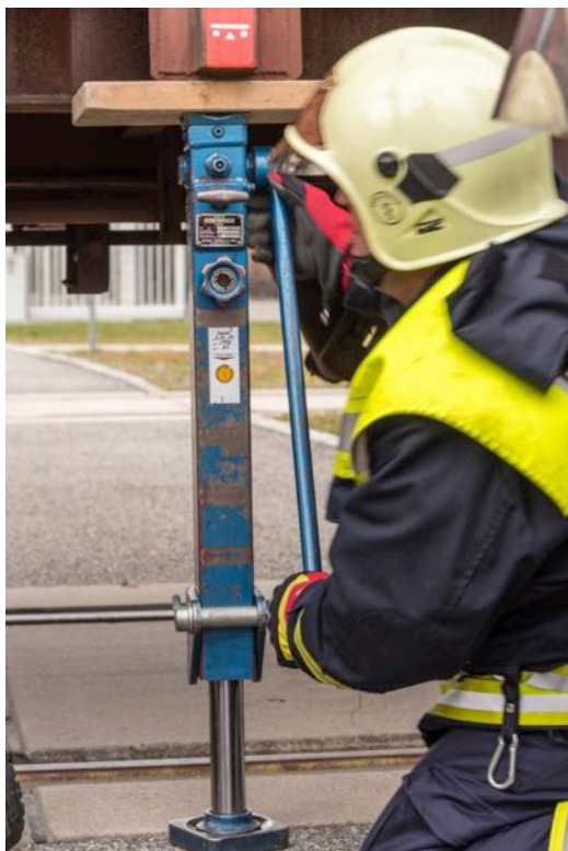
Abbildung 44: Anheben mittels Büffelheber
