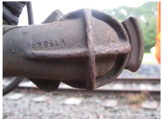
Abbildung 36: Gekennzeichneter Luftkopf einer Hauptluftbehälterleitung
