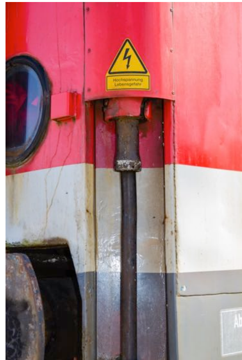
Abbildung 37: Nicht verbundene Zugsammelschiene an einem Reisezugwagen
