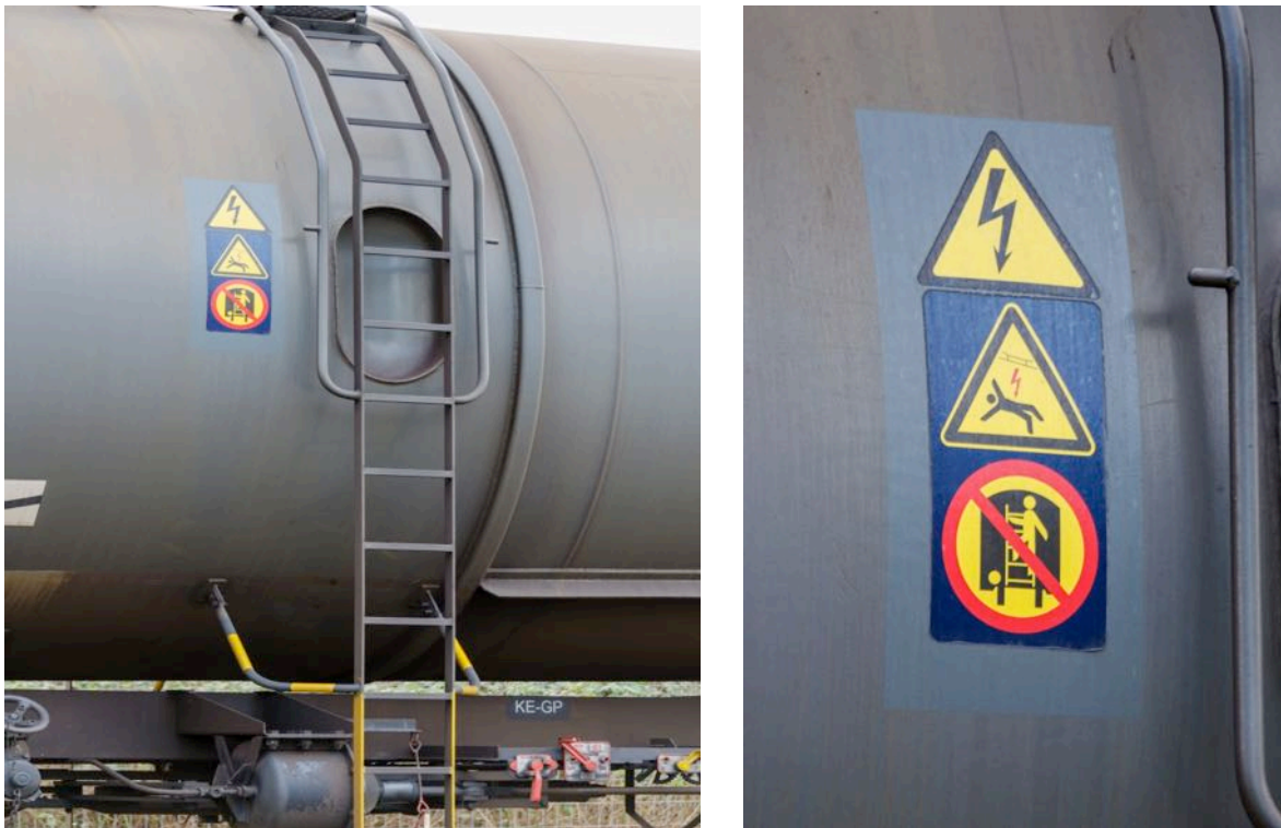
Abbildung 4: Warnhinweis Oberleitung an Fahrzeugen
