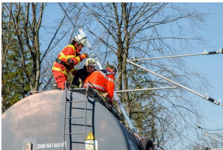
Abbildung 59: Absturzgefahr besteht in den Dachbereichen von Eisenbahnfahrzeugen
