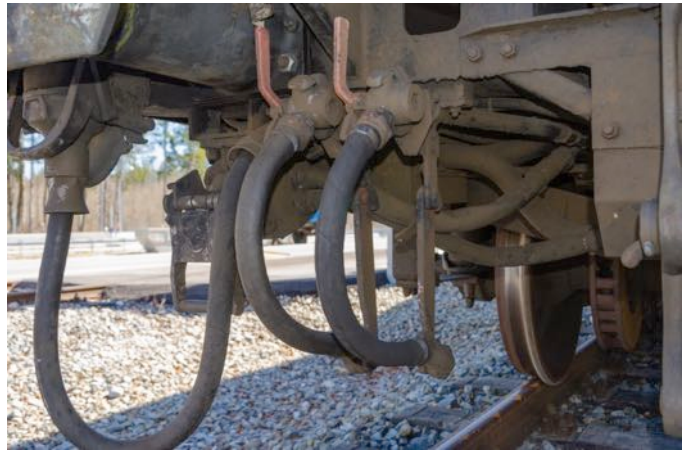
Abbildung 35: Luftleitungen mit Luftabsperrhähnen
