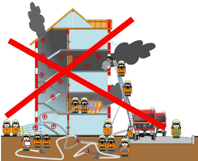
Abbildung 6: Bei einer Menschenrettung über Leitern aus verrauchten Bereichen darf keine maschinelle Lüftung erfolgen!
