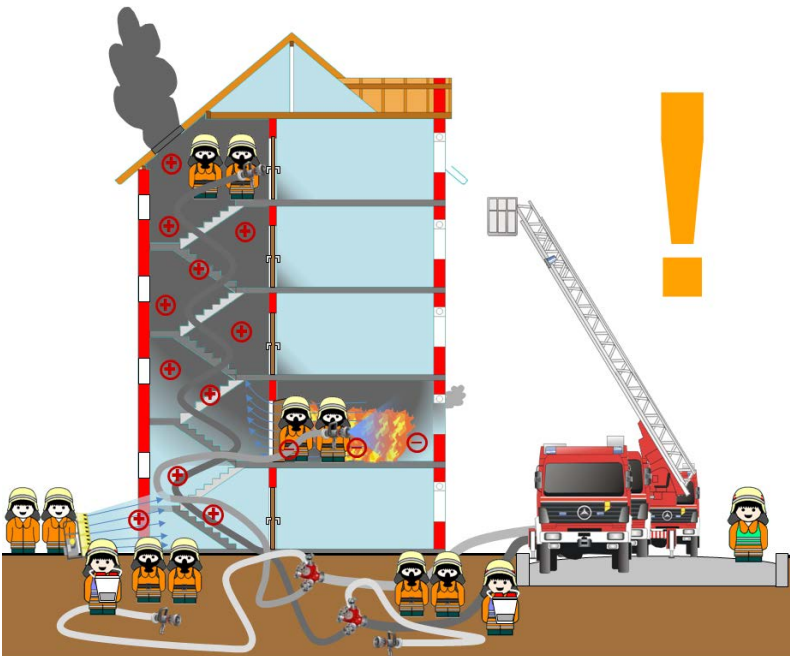
Abbildung 4: Bei der Belüftung des Treppenraumes kann es unter Umständen auch zu einem Ansaugen von Rauchgasen aus dem Brandraum in den Treppenraum kommen.
