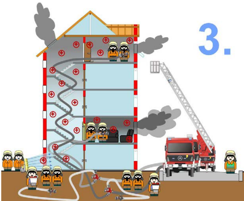
Abbildung 10: Phasenweise Entrauchung mehrerer Geschosse
