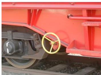
Abbildung 10: Bodenhandbremse an Güterwagen
