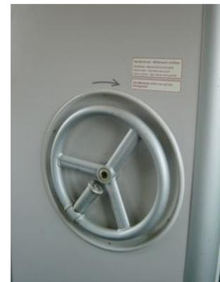
Abbildung 9: Handbremse in Reisezugwagen
