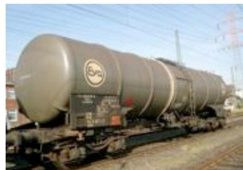
Abbildung 6: Mineralölkesselwagen
