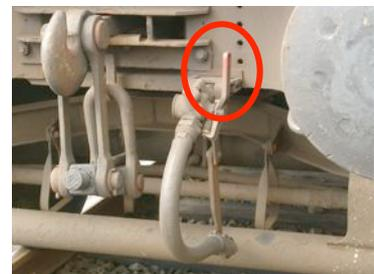
Abbildung 8: Luftabsperrhahn
