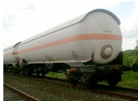
Abbildung 5: Druckgaskesselwagen
