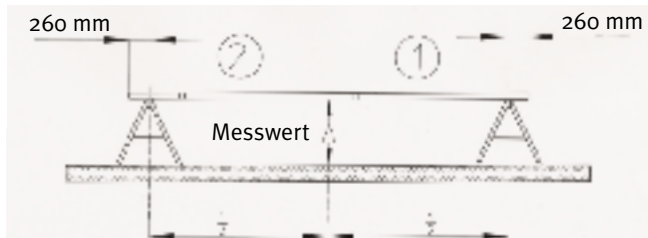
Bild 3: Unbelastete, umgesteckte Leiterteile
