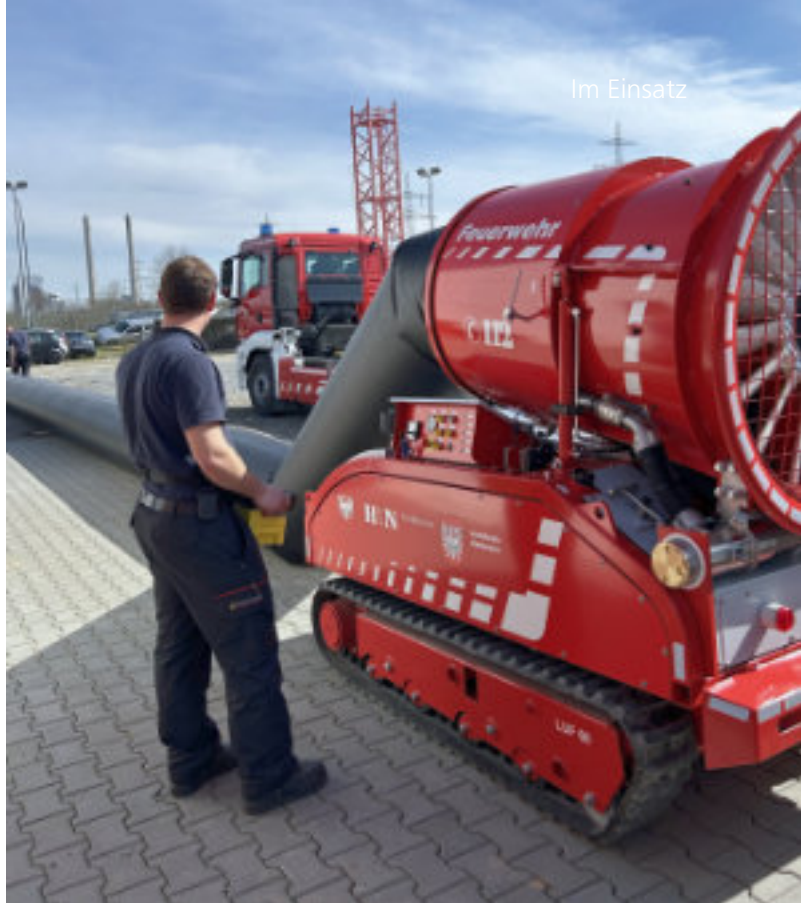
Belüftung über einen angebauten Luttenschlauch
