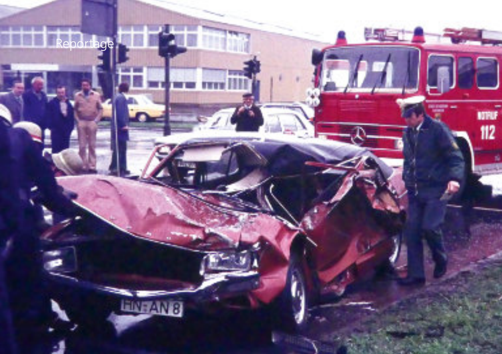
Auf diesen Bildern ist die steife Konstruktion bzw. die fehlende Knautschzone der verunfallten Fahrzeuge zu erkennen
