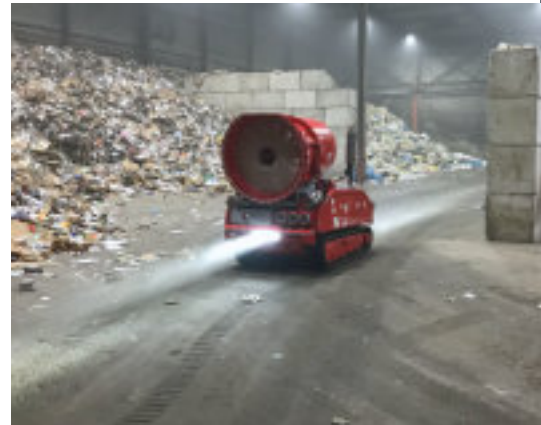
LUF60 bei Entrauchungsmaßnahmen in der Halle
