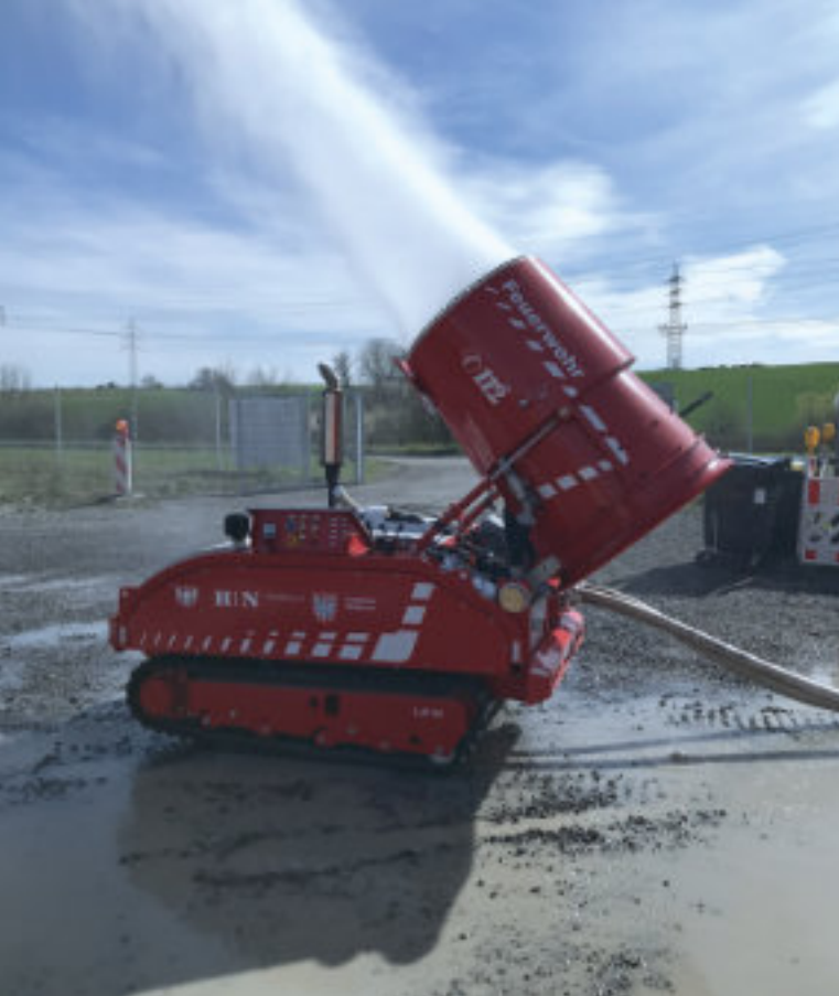
Fein vernebelter Wasserstrahl über den Ventilator
