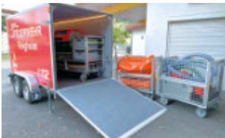
FF Roigheim MZA mit Platz für 4 Rollcontainer
